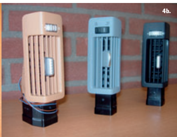
4a en b. Technoplast heeft de luchtventilatiestroosters van de Volvo V40 (links) en de Porsche Cayenne (rechts) gespuitsgiet.
